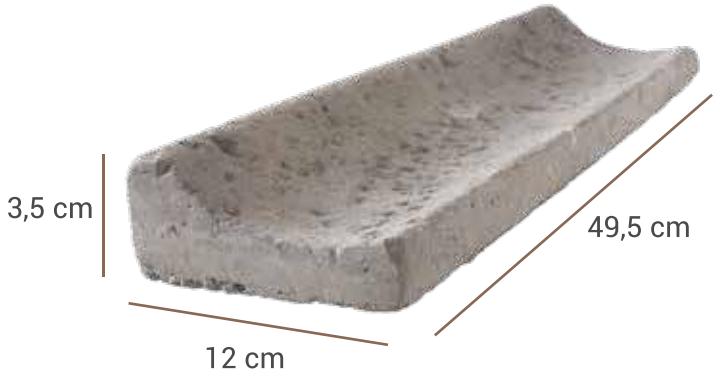
Jamb-flat Jambage-plat Düz Söve
